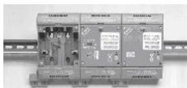
Le morsettiere M-DIN-1D/2D forniscono un'interfaccia tra un modulo LonPoint e la rete, alimentazione e collegamenti I/O. Sono studiate per essere installate su guide DIN di 35mm x 7,5mm o 35mm x 15mm (su muro o quadro), a parete, all'interno del quadro elettrico.
