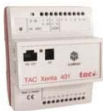
Unità di controllo per pilotare fino a 10 moduli di espansione della serie XENTA 400, presa RJ11 per la connessione del terminale portatile OP (non fornito) comunicazione con altre periferiche tramite protocollo standard LonWorks®. Dotata di porta seriale RS232 per modem esterno.
