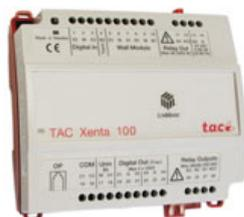
Preconfigurato per unità terminali fancoil, con controllo delle tre velocità certificato LonMark®, permette di gestire un singolo fancoil a 2 tubi con o senza valvola o 4 tubi con valvola. 6 differenti programmi operativi (regime normale/ridotto e boost). Presa jack per la connessione con terminale portatile XENTA OP.
