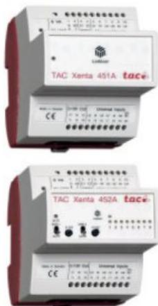
I moduli della serie XENTA 451/452A possono essere applicati ai regolatori XENTA 301, 302 e 401 per aumentare i punti controllati dal sistema. XENTA 452A è equipaggiato di LED indicatori di status, uno per ogni ingresso universale quando utilizzato per ingressi digitali. selettori on, off e auto con potenziometri sulle uscite.
