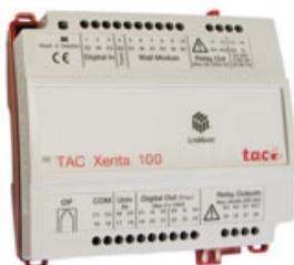
Controllore DDC configurabile, certificato LonMark®, per unità terminali VAV. Consente la commutazione via rete tra le funzioni di riscaldamento e raffreddamento. Può essere utilizzato come unità stand-alone o integrato in reti LonWorks® Vista®. Supporta i moduli STR ed il pannello Xenta OP per il controllo dei setpoint e delle variabili d'ambiente.
