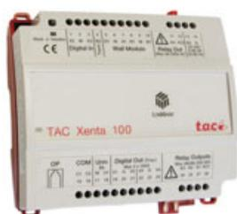
Controllo integrato della temperatura ambiente per sistemi fancoil a 4 tubi con consenso ventilatore e controllo valvole abbinabile al modulo a parete multifunzione della famiglia STR. 6 differenti programmi operativi (regime normale/ridotto e boost). Porta di comunicazione TP/FT-10 per rete con protocollo standard LonWorks. Uscita 24 V AC per alimentazione XENTA OP.
