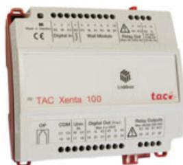
Regolatore preconfigurato per la gestione di una unità roof-top, AHU o unità ventilante caldo/freddo con funzione di recupero certificato LonMark®. 6 differenti programmi operativi (regime normale/ridotto e boost). Porta di comunicazione TP/FT-10 per rete con protocollo standard LonWorks®.
