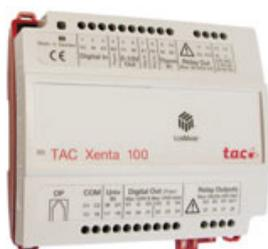
Controllo integrato della temperatura ambiente mediante pannello multifunzione della serie STR e controllo illuminazione per 2 zone. 6 differenti programmi operativi (regime normale/ridotto e boost). Presa jack per la connessione con terminale portatile XENTA OP. Porta di comunicazione TP/FT-10 per rete con protocollo standard LonWorks®
