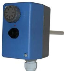
Con elemento sensibile incapsulato in guaina protettiva in ottone con testa esagonale 1/2" G. Adatto per applicazioni di tipo industriale, per il controllo della temperatura di liquidi non corrosivi. Realizzato in contenitore stagno, è particolarmente indicato per l'installazione in ambienti a forte inquinazione (polverosi e umidi).
