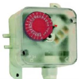
SPD900 è un pressostato differenziale per il controllo della pressione differenziale dell'aria nei canali, filtri e ventilatori. Una manopola di comando con scala graduata permette una facile regolazione. Il presso stato SPD900 è fornito completo di tubo da 2 m e 2 attacchi in plastica. Fluido controllato: aria e gas non aggressivi.
