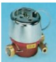
A turbina con attacchi filettati, ad orologeria asciutta, sottovuoto, orientabile e a lettura diretta con 4-5 rulli numeratori. Le sue caratteristiche ne consentono l'impiego su circuito con acqua calda fino a 120 °C. E' completo di trasmettitore di impulsi reed (K=10L) ed è predisposto per ricevere un sensore di temperatura. Completati di dadi, raccordi e guarnizioni per il montaggio su tubazioni
