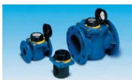
Esecuzione standard PN 10/16, Disponibile PN 25/40; possibilità di montare diverse orologeri MULTI-PULSE (trasmettitori; reed, NAMUR, fotoelettrico), MULTI-PULSE-TROPIC (trasmettitori; reed, optoelettronico bidirezionale), MULTI-BUS (uscita M-BUS meter-bus -EN 1434); sistema di lettura bidirezionale; montaggio in posizione orizzontale, verticale o inclinato.
