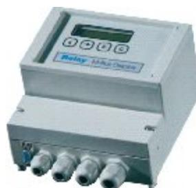
Ideale per gli impianti M-Bus fino a 60 nodi. Il modello base è il Convertitore di Livello M-Bus che è equipaggiato con le interfacce RS232 e RS485 e display LCD che consente tutte le operazioni in tempo reale. È possibile effettuare le letture di tutti i parametri con pochi comandi dalla tastiera e trasferire i dati direttamente a un PC o in remoto via modem.
