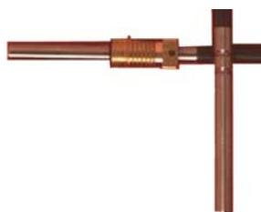
Questo piccolo sensore consiste di un resistore Pt100/Pt500, incapsulato in uno schermo di metallo. I sensori possono essere usati sia per il montaggio diretto, insieme ad un corredo del montaggio, che anche senza questo corredo per il montaggio in pozzetti porta sonde. I sensori sono forniti con un cavo di 2 metri. Possono essere montati in un sensore di flusso predisposto o nelle valvole a sfera o in tubi a T.
