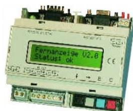
CC-20 è ideale per i piccoli impianti M-Bus. Installazioni da 3 a 20 dispositivi. Il modello base è il Convertitore di Livello M-Bus che è equipaggiato con l'interfaccia RS232C e display LCD che consente tutte le operazioni in tempo reale. È possibile effettuare le letture di tutti i parametri con pochi comandi dalla tastiera e trasferire i dati direttamente a un PC o in remoto via modem.
