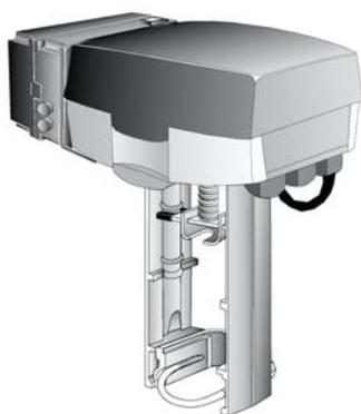
STS è un dispositivo controllato da un processore, con una batteria ausiliaria che fornisce un controllo della presenza di tensione. Il dispositivo chiude la valvola nell'evenienza di una perdita di tensione. La batteria è testata e tenuta carica durante il normale periodo di operazione. Le batterie per STS sono di tipo ecologico. (NiMH).
