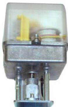
MB30B è un servomotore elettromeccanico per la motorizzazione delle valvole a farfalla modello TRV-S disponibile per alimentazione a 24 V e 230 V ed è controllato da un segnale a tre punti. Il campo di rotazione del servomotore è impostato in fabbrica a 90° per adattarsi con TRV-S. MB30B può essere attivato manualmente, un indicatore fra il servomotore e la valvola segnala la posizione della valvola.
