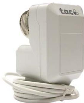
Il servomotore MZ18B è progettato specificatamente per il controllo a 3 punti delle valvole VZ22, VZ32 e VZ42 e può essere utilizzato sulle valvole per fancoil, nelle unità ad induzione, per applicazioni del controllo ambiente e per piccole unità calde e fredde. Un lungo periodo di operatività viene assicurato dal fatto che non è necessario alcun potenziometro meccanico e fine corsa, grazie ad una funzione di sincronizzazione del punto di chiusura automatica.
