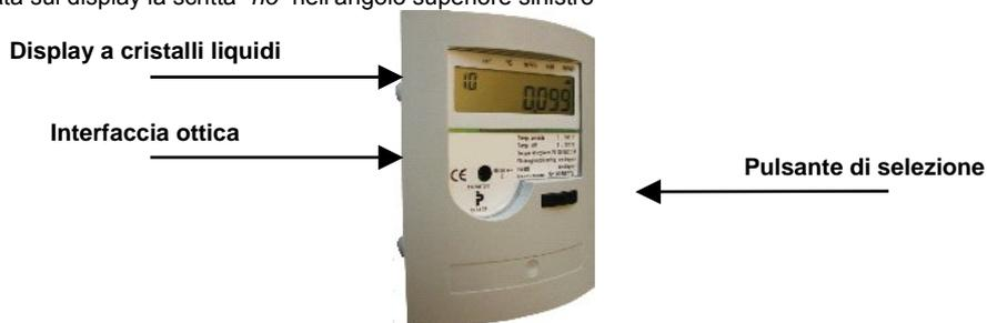
Per effettuare l'attivazione del contatore d'energia ME2-EI passando alla modalità operativa (*operating mode*) occorre premere il pulsante di selezione nero, posto sulla destra sotto il display, per circa 5 secondi, finché non appaia, nella parte in alto a sinistra, il codice di riferimento della grandezza visualizzata ed il simbolo ▲ in alto a destra che si posizionerà in corrispondenza dell'unità di misura utilizzata.
