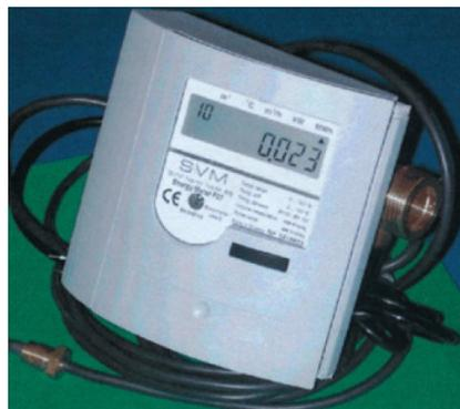
MEC2U è un contatore di calore per il calcolo e il controllo del consumo di energia termica. Il contatore MEC2U è uno strumento flessibile e compatto dotato di un sensore di portata ad ultrasuoni. L'unità di calcolo può essere montata sul sensore in quattro diverse posizioni o a parete (modello split).
