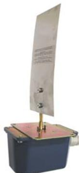
Flussostato per il controllo del flusso di aria o gas non aggressivi, all'interno dei condotti di distribuzione per impianti di condizionamento o trattamento aria. Il flussostato, su basetta in lamiera galvanizzata con coperchio in ABS, stagno IP65 (sul lato esterno al canale) secondo la norma EN 60529 (ex IEC 529), classe protezione I - norma EN 60335-1 (ex IEC 335-1).
