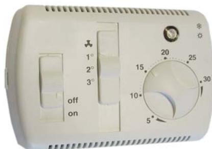
Termostato elettronico per la regolazione della temperatura ambiente con selettore manuale delle tre velocità (min. med. max.), commutatore estate / inverno, interruttore generale, controllo della temperatura di tipo on/off tramite relè; adatto ad impianti di condizionamento dell'aria con ventilconvettori (TFM-P modello a parete, TFM-BM modello a bordo macchina).
