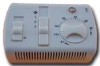
TFMR-P/BM è un termostato elettronico per la regolazione della temperatura ambiente in impianti di condizionamento dell'aria con ventilconvettori, è dotato di un selettore manuale di velocità, interruttore acceso/spento, controllo temperatura di tipo on/off, comando remoto e funzione estate/inverno.
