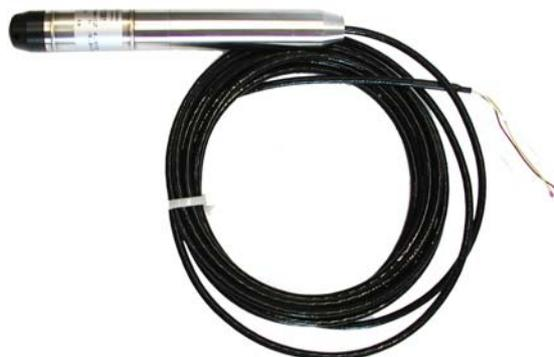
Sonda di pressione per la misurazione del livello di liquidi, di facile installazione; è sufficiente immergerla nel liquido per ottenere il livello. Indicata per la misurazione del livello in cisterne di acqua o gasolio. Dotata di compensazione automatica della pressione ambiente
