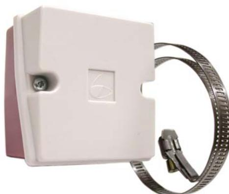
La sonda EGA è studiata per il montaggio direttamente sulla tubazione. Per assicurare una conduzione termica ottimale alla piastra di contatto e quindi al termistore dell'EGA, la sonda EGA deve essere montata su un tratto di tubazione non isolata. Installazione elettrica: Ø 19 foratura per ingresso cavo e conduttori.
