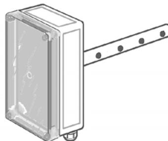
Il sensore ambiente GKD 2001VT(d) e il sensore di canale GKD 2001VTk(d), con o senza display sono sensori completamente digitali progettati per monitorare il livello nell'aria di biossido di carbonio e possono essere usati come sensori di qualità dell'aria. Una camera campione coperta da una membrana è composta da un sensore di biossido di carbonio stabile e molto preciso.
