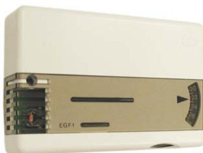
L'EGF1 è un sonda ambiente a termistore, studiata per il controllo della climatizzazione in piccoli ambienti da posizionarsi in zone dove l'aria può circolare liberamente. La temperatura può essere impostata nei valori compresi tra 10 / 30°C. Il collegamento deve essere effettuato in accordo con gli schemi dei singoli regolatori che vengono utilizzati con la presente sonda.
