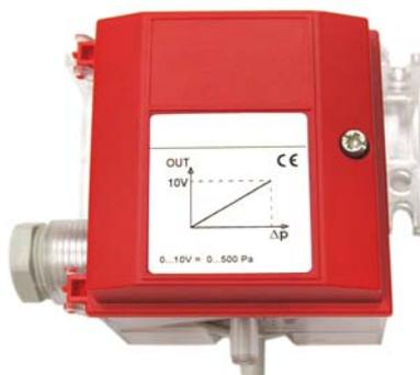
La sonda di pressione differenziale della serie SPD-A presenta una tecnologia a fulcro ceramico incorporato. Essa fornisce un segnale calibrato, compensato con la temperatura di lavoro, disponibile in tensioni standard o con uscite in corrente. La calibrazione e l'amplificazione del segnale garantiscono:
