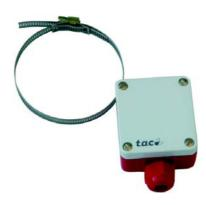
La sonda STC100/101 è studiata per il montaggio direttamente sulla tubazione. Per assicurare una conduzione termica ottimale alla piastra di contatto e quindi al termistore dell' STC100 / 101, la sonda deve essere montata su un tratto di tubazione non isolata. Il contenitore della sonda STC100 è provvisto di un pressacavo Pg11. Il contenitore della sonda STC101 presenta un foro di Ø 20 mm per il passaggio del cavo.
