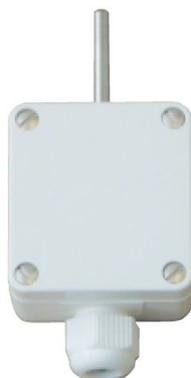
Sonda di temperatura attiva per esterni con conversione del valore di temperatura misurato in un segnale di corrente 4-20mA. Completa di contenitore e basetta in policarbonato autoestinguente per montaggio diretto su parete e resistente all'azione dei raggi ultravioletti.
