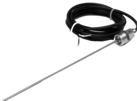
STX122 è una sonda ad immersione studiata per essere installata all'interno dei tubi che presentano una tasca apposita per la misurazione della temperatura dell'acqua. L'elemento sensibile è in acciaio inossidabile. Il sensore è equipaggiato con un cavo di 2m e con due filettature. Una con DN8 maschio e l'altra con DN15 maschio per permettere la riduzione della boccola.
