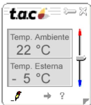
Applicazione software che permette all'utente finale di visualizzare e modificare il comfort del proprio posto di lavoro agendo direttamente dalla propria postazione. Necessita di collegamento in rete con un server Vista IV.
