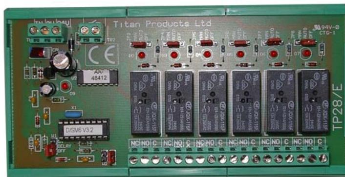
Il TI-IO/DOM6 è un modulo convertitore di 1 ingresso analogico in 6 uscite digitali commutabili singolarmente. In modalità sequenza il modulo incorpora un temporizzatore per inserire eventuali ritardi sulle abilitazioni delle uscite e per partenze ritardate dopo il verificarsi di una mancanza di tensione. In modalità binaria il modulo fornisce 16 combinazioni di uscite diverse in funzione del segnale in ingresso ricevuto.
