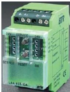
Modulo espansione punti comunicazione per reti Lonworks-FTT10, innesto su barra DIN, alimentazione 24 V AC/DC, con 4 uscite digitali. Adatto per comandare componenti elettrici come motori, contattori, lampade..ecc. Per alti carichi induttivi consigliamo di proteggere i contatti in uscita ulteriormente con opportuni relè di interfaccia.
