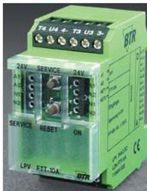
Modulo espansione punti comunicazione per reti Lonworks-FTT10, innesto su barra DIN, alimentazione 24 V AC/DC, con 4 ingressi per sensori di temperatura PT1000 e 4 ingressi in tensione 0-10V DC. Nell'installazione LON tutti gli 8 ingressi possono essere decifrati contemporaneamente mediante variabili network standard SNVT. Aggiornamenti del software del dispositivo sono disponibili solo in fabbrica.
