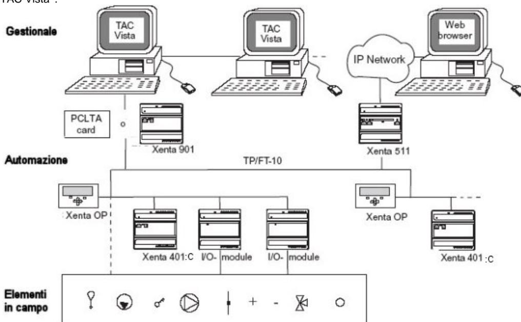
La figura mostra un esempio di configurazione in *network* dello XENTA. I sensori e gli attuatori installati in campo sono collegati agli ingressi ed alle uscite dei regolatori e dei moduli di espansione punti. Alcune unità esterne, tuttavia, possono essere collegate direttamente al *network* per la comunicazione di dati relativi agli ingressi ed alle uscite mediante l'utilizzo delle variabili del network.
