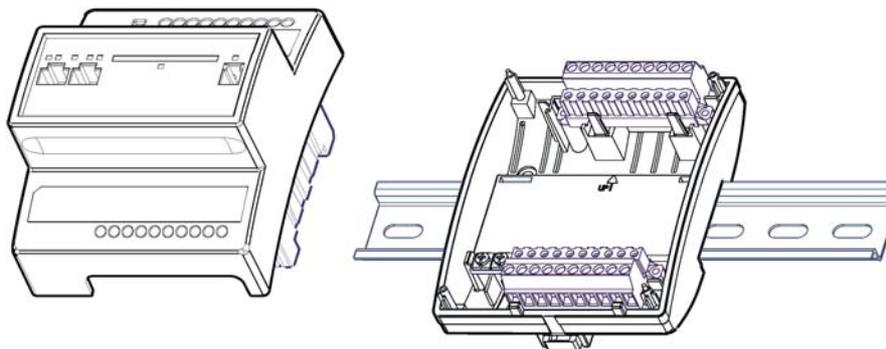
Il regolatore è studiato soltanto per l'installazione all'interno di un quadro e può essere montato su guida DIN o fissandolo su una piastra utilizzando la preforatura della morsetteria.
